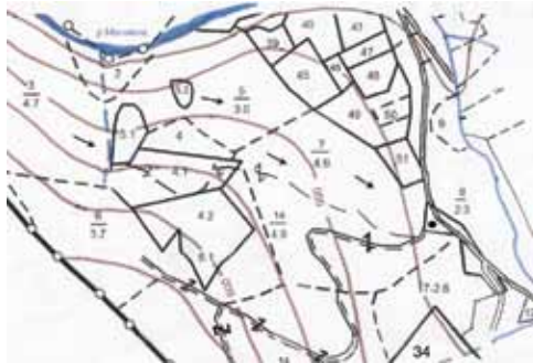
Рис. 13. Технологічна схема рубки із застосуванням канатного трелювання.
